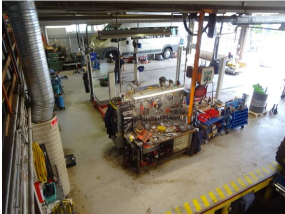
Værksted, epoxy gulv og vægelementer i baggrunden
